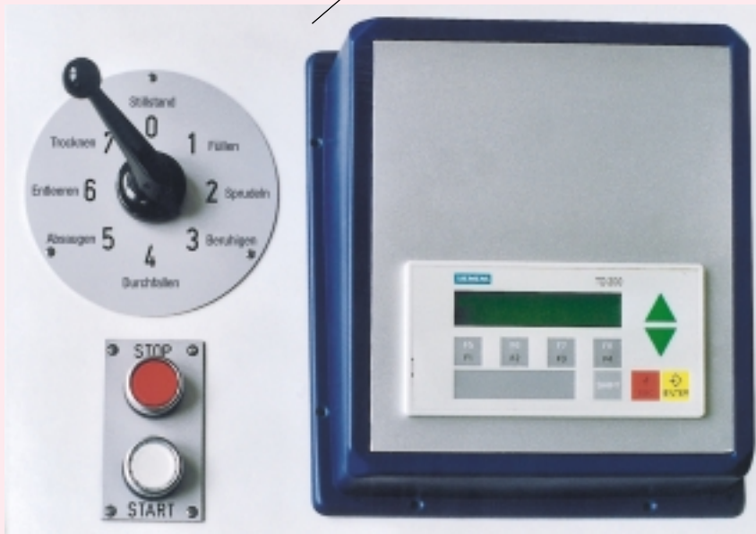
BBS-Bedienungselemente und Programmanzeige für Blattbildungssäule
